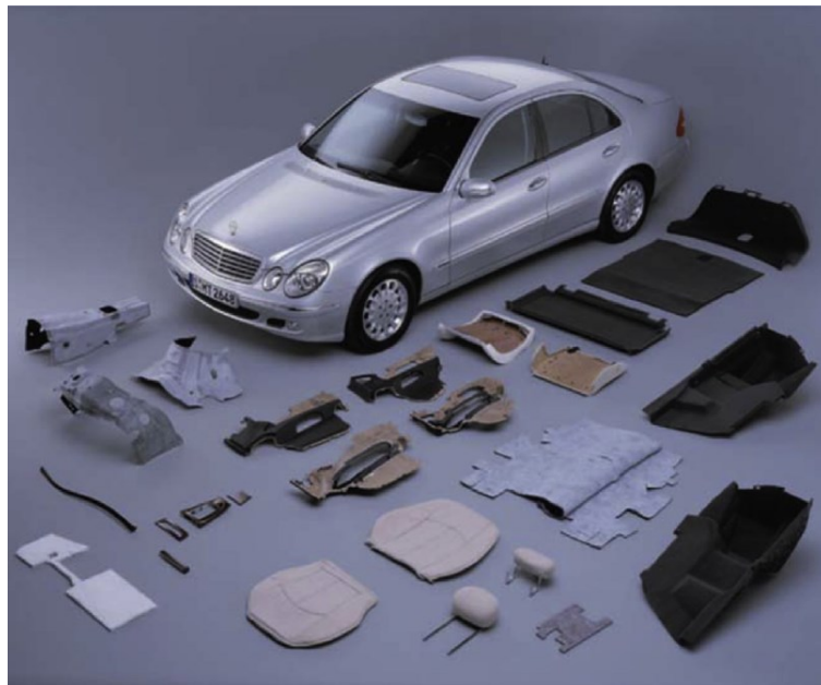
Figura 1 - Painéis, tampos e revestimentos internos utilizados no automóvel Classe E da Mercedes-Benz produzidos com material polimérico reforçado com fibras vegetais, como linho e sisal.
