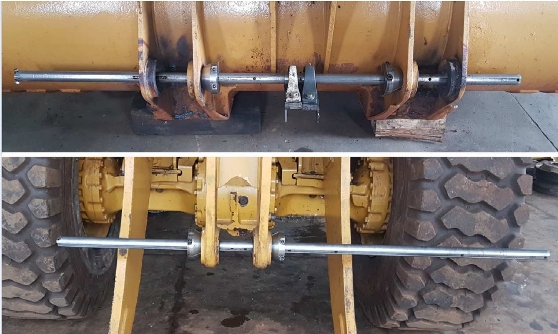
Figura 56 – Montagem buchas cônicas. superior em X e inferior em O
