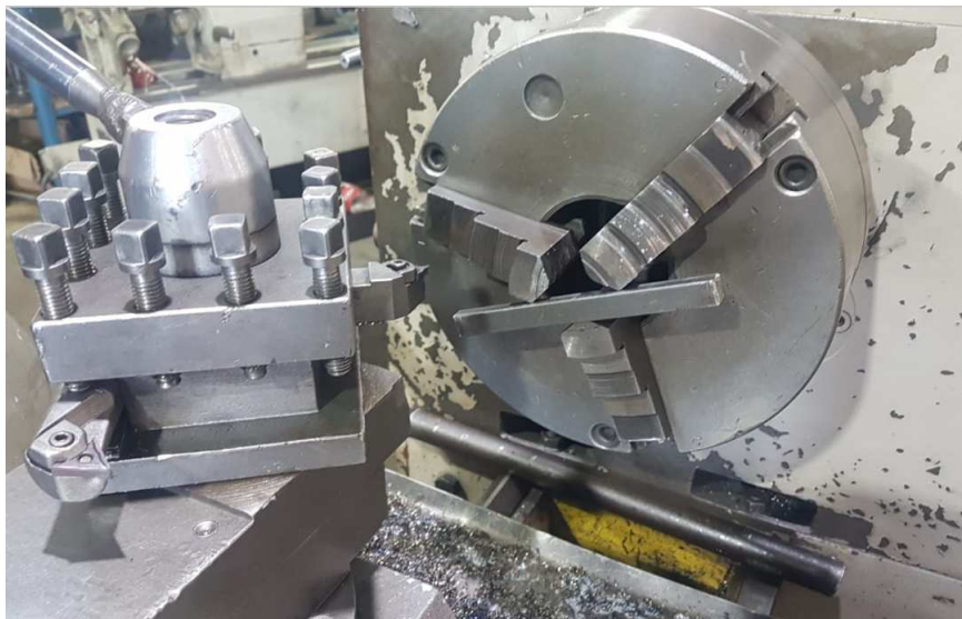
Figura 44 – Usinagem da chaveta
