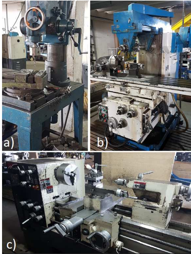
Figura 36 – Equipamentos utilizados para a fabricação do protótipo: (a) furadeira radial; (b) fresadora horizontal; (c) torno mecânico.
