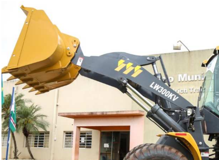
Figura 38 – Articulação de uma carregadeira hidráulica
