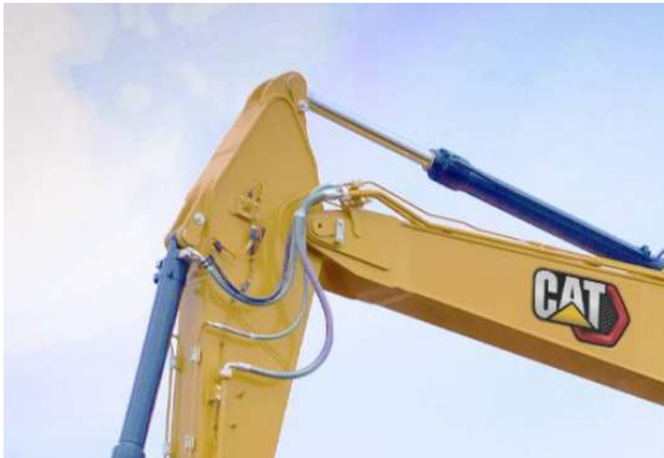
Figura 37 – Articulação de uma escavadeira hidráulica
