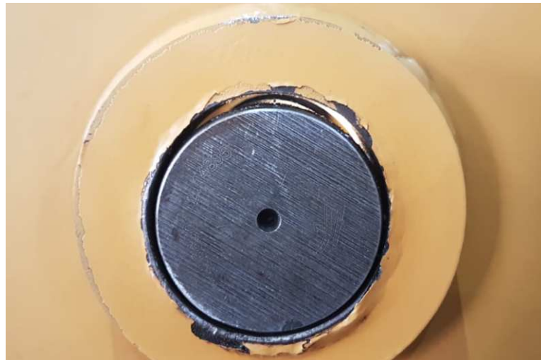
Figura 60 – Furo defeituoso com excentricidade
