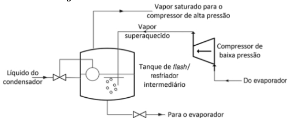
Figura 6 - Ciclo com resfriamento intermediário
