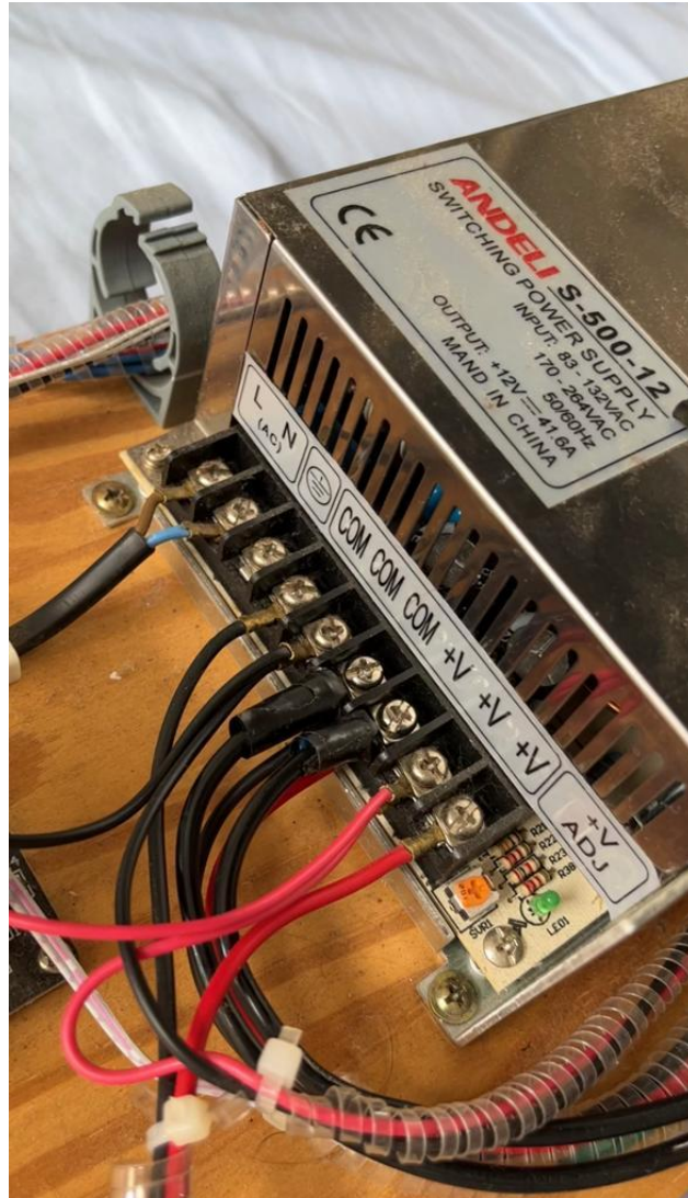
Figura 48 – Conexões na fonte, com os quatro fios para a alimentação da placa Shield , sempre respeitando positivo e GND
