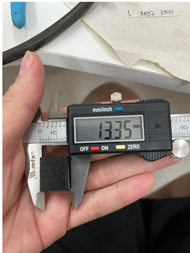
Figura 57 – Medidas do cubo impresso final para constatação de parametros e iteração de cálculo de micro passos no eixo X
