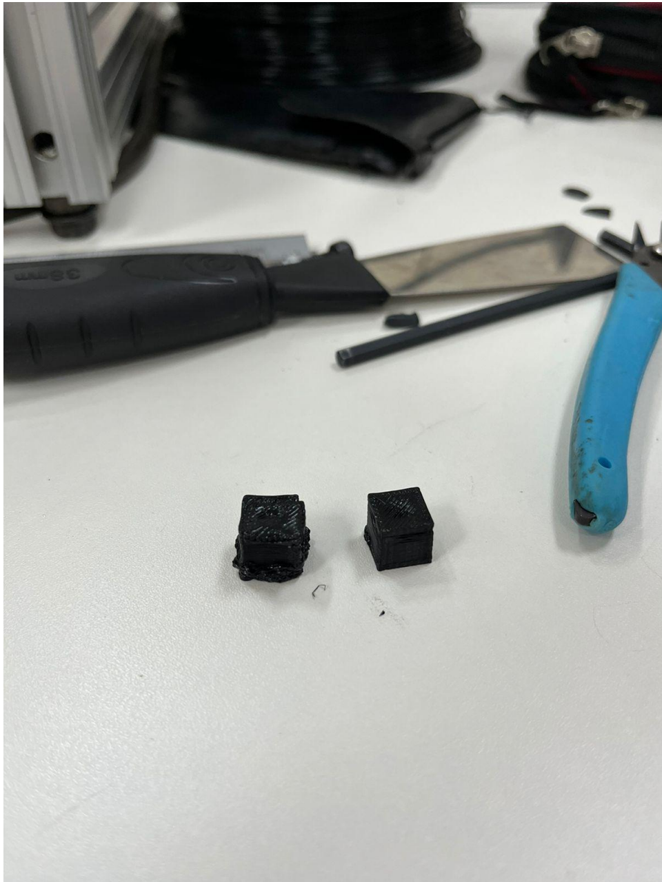
Figura 56 – Ajustes de temperatura de impressão e micro passos gerando uma impressão mais precisa
