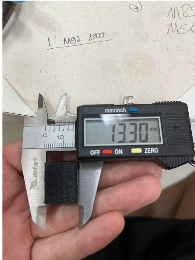
Figura 58 – Medidas do cubo impresso final para constatação de parametros e iteração de cálculo de micro passos no eixo Y
