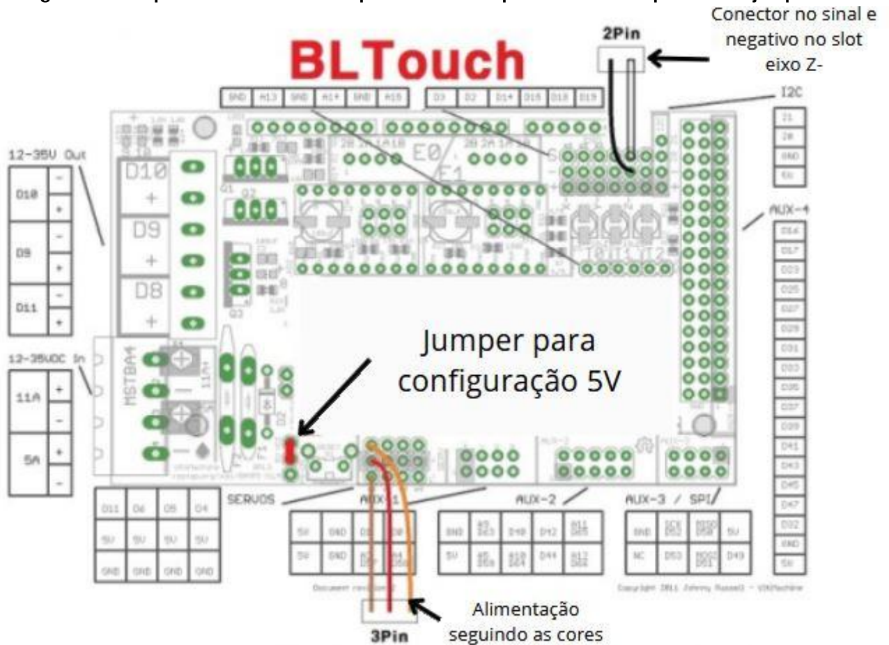
Figura 44 – Esquemático de conexões para BLtouch na placa Shield Ramps 1.4 com jumper
