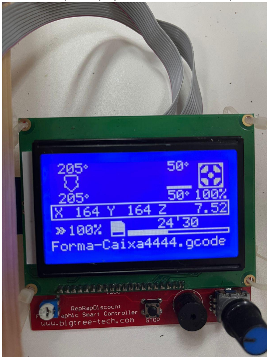
Figura 53 – Tela LCD Full Graphics RepRap 128 mm x 64 mm durante impressão de componente
