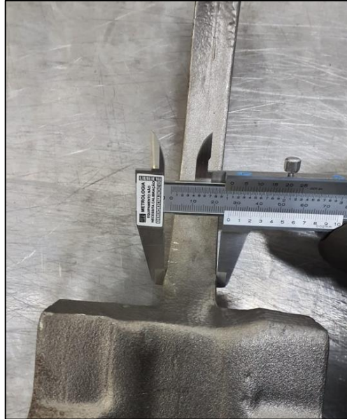
Figura 19 – Espessura do gancho após 3 meses de utilização
