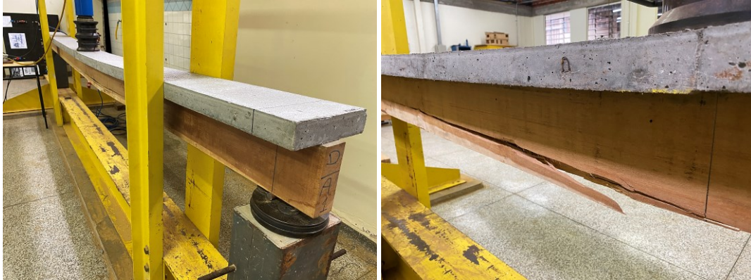
Figura 36 - Rompimento da viga 1
