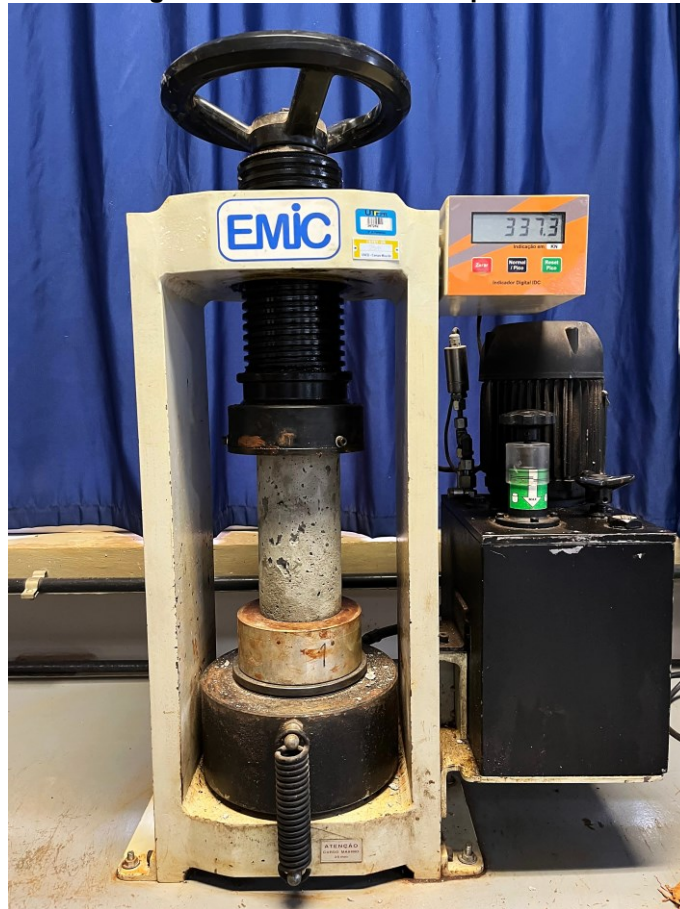
Figura 20 - Ensaio de compressão
