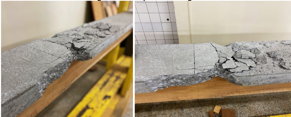
Figura 37 - Rompimento da viga 2
