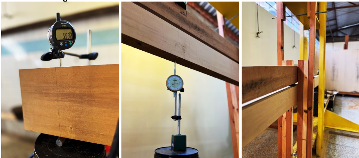
Figura 19 – Transdutores de deslocamento e contraentamento
