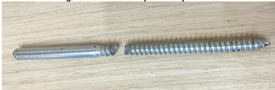
Figura 30 - Modo de ruptura dos parafusos
