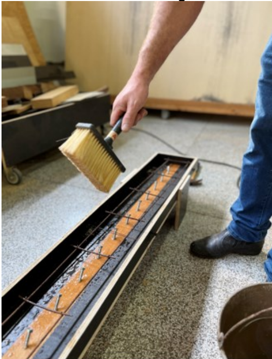
a) Preparando a viga para ser concretada
