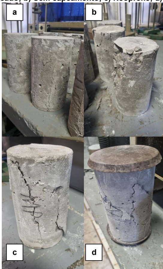
Fotografia 27: tipos de ruptura dos corpos-de-prova após ensaio de compressão a) Retificado; b) Sem capeamento; c) Neoprene; d) Enxofre.
