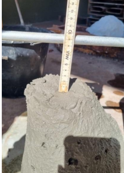
Fotografia 7: Ensaio de consistência pelo abatimento de tronco de cone ( slump test )
