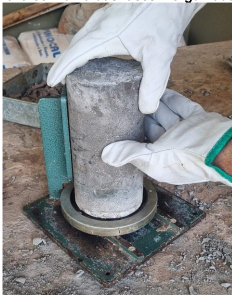
Fotografia 20: Corpo de prova com uma das faces mergulhada na argamassa de enxofre
