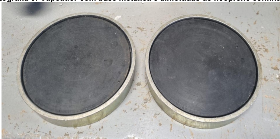
Fotografia 3: Capeador com base metálica e almofadas de neoprene confinadas
