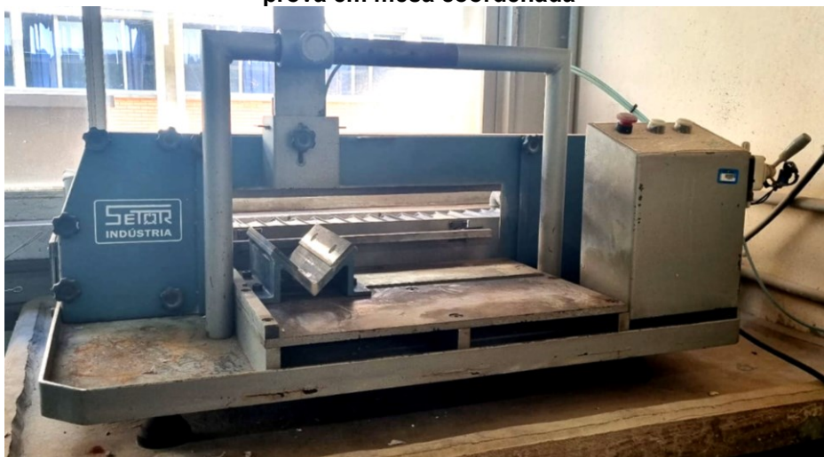
Fotografia 5: Máquina Retificadora com disco adiamantado fixo e movimentação do corpo-de-prova em mesa coordenada
