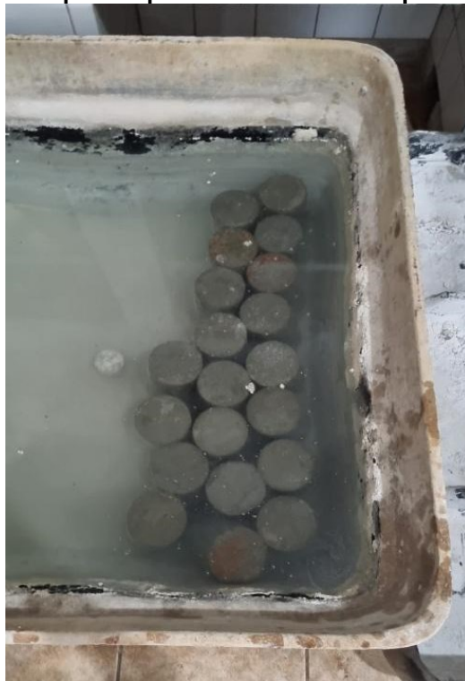
Fotografia 9: Corpos de prova imersos em tanque de cura úmida
