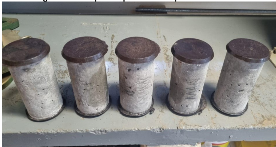
Fotografia 22: Corpos de prova com capeamento de enxofre
