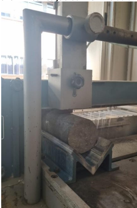
Fotografia 4: Retificação com lâmina adiamantada
