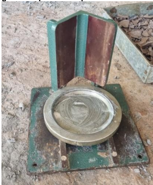
Fotografia 18: prato do capeador untado com óleo
