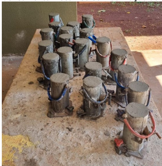
Fotografia 8: Adensamento mecânico com utilização de mesa vibratória
