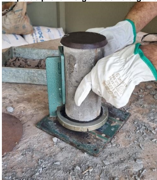
Fotografia 21: Corpo de prova mergulhado na argamassa de enxofre
