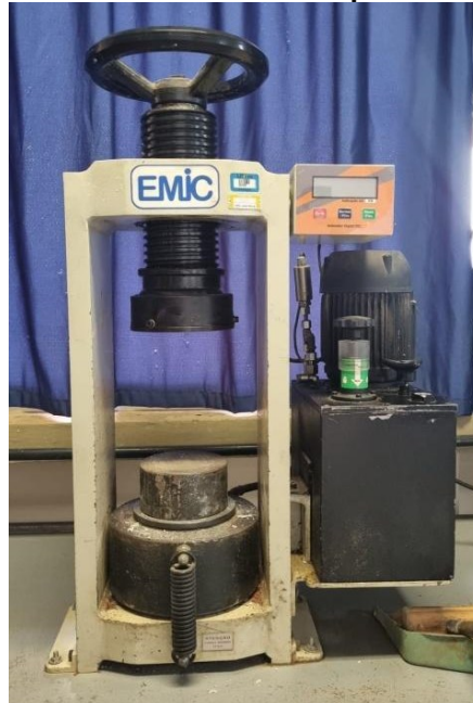
Fotografia 6: Prensa eletro-hidráulica com capacidade de carga de 2000 kN
