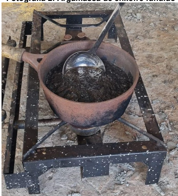
Fotografia 2: Argamassa de enxofre fundido
