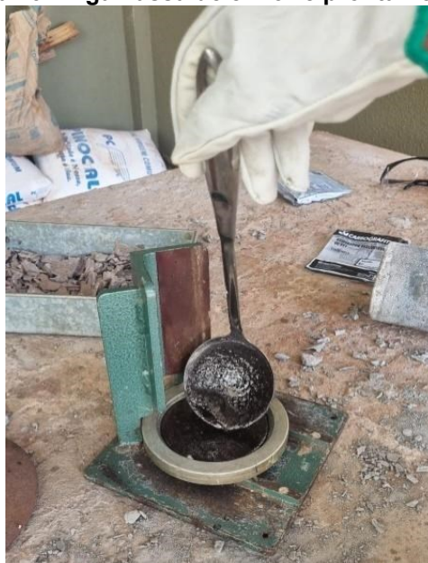
Fotografia 19: Argamassa de enxofre pronta no capeador
