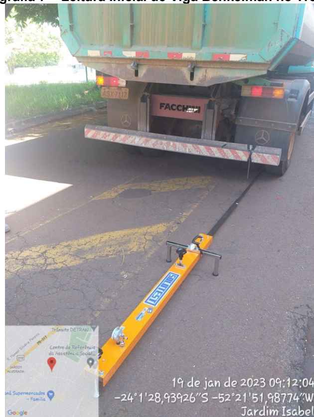
Fotografia 7 – Leitura Inicial de Viga Benkelman no Trecho 2
