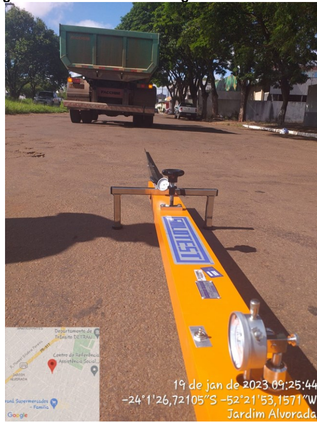
Fotografia 6 – Leitura Final de Viga Benkelman no Trecho 1
