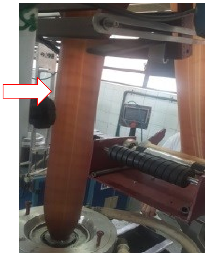
Figura 03 – Embalagem biodegradável na extrusora sopra balão contendo corante natural da casca do pinhão
