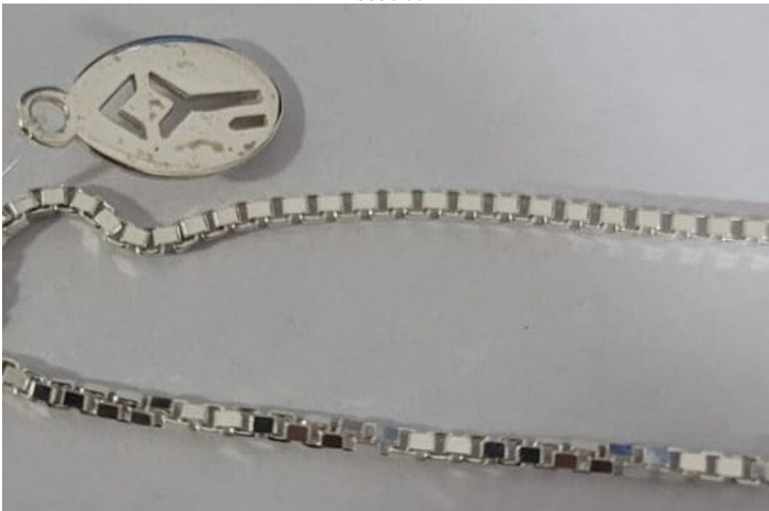
Figura 8 - Comparação entre a TAG após o 5º ciclo do 1º ensaio de imersão e a corrente como recebida
