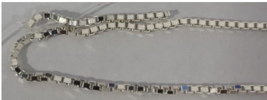
Figura 10 - Comparação entre os elos da corrente após o 5º ciclo do 1º ensaio de imersão e da corrente como recebida.
