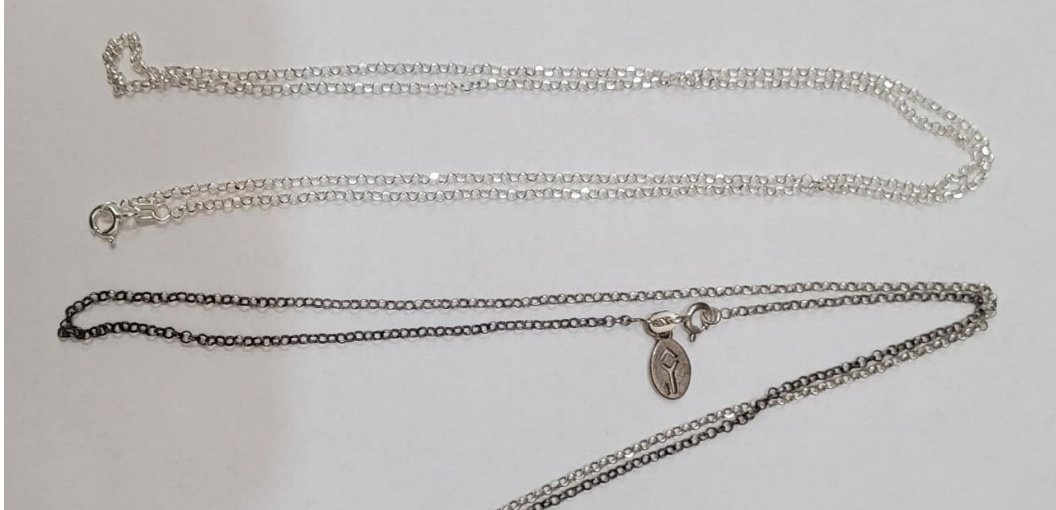
Figura 3 - Comparativo entre duas correntes do mesmo modelo. Corrente brilhante (não oxidada); Corrente escura (oxidada)
