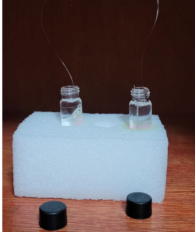
Figura 5 - Demonstração do aparato para imersão das amostras
