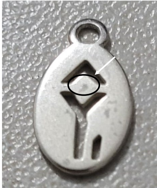
Figura 11 - Mancha em destaque na TAG após a limpeza.
