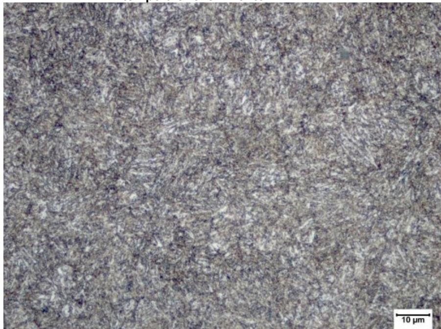
Figura 7: Aspecto de uma estrutura típica do aço SAE 4140 de martensita revenida após têmpera e revenimento.
