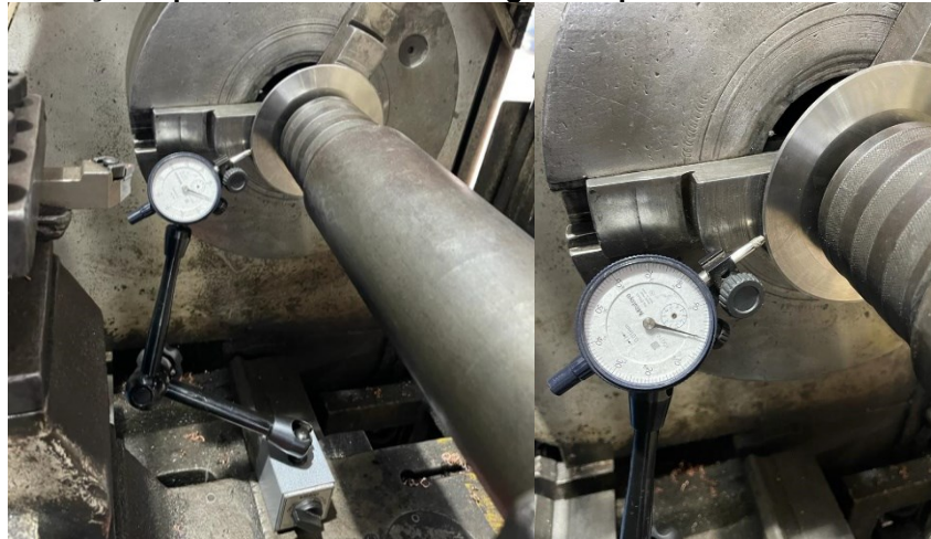
Figura 16 – Fixação e posicionamento do relógio comparador no fio de corte das facas
