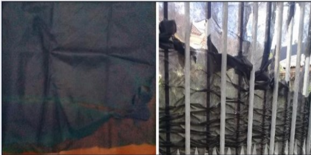
Figura 27 – Danos ao nãotecido após longo período de exposição
