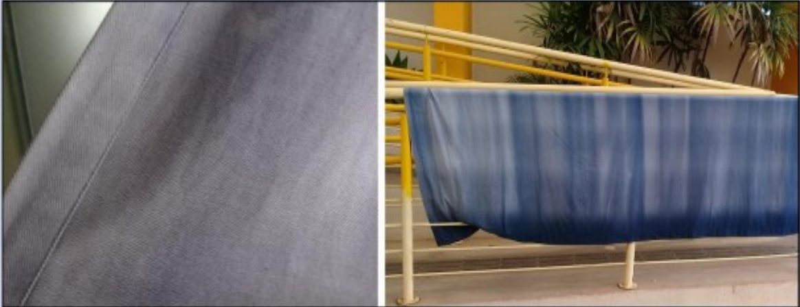
Figura 24 – Danos ao tecido após longo período de exposição
