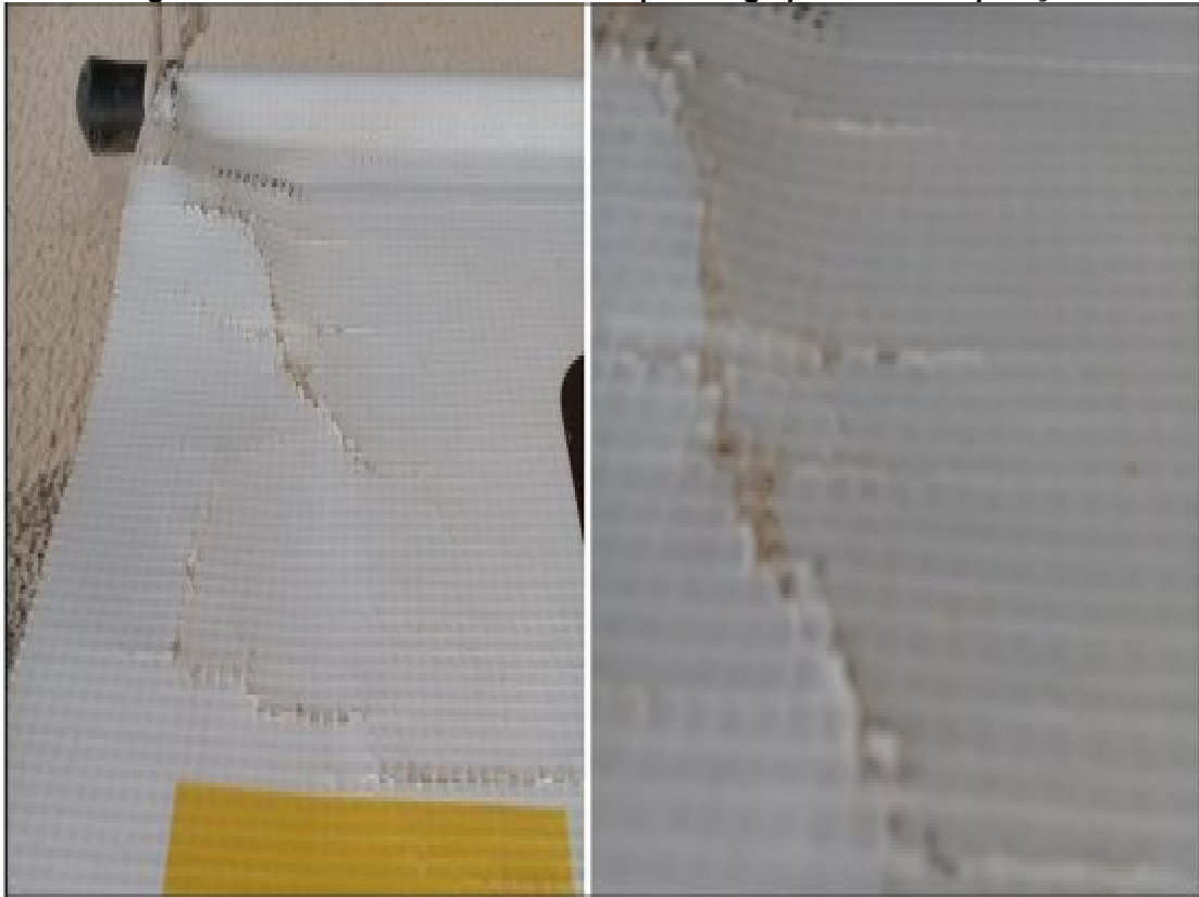
Figura 22 – Danos ao laminado PVC após longo período de exposição
