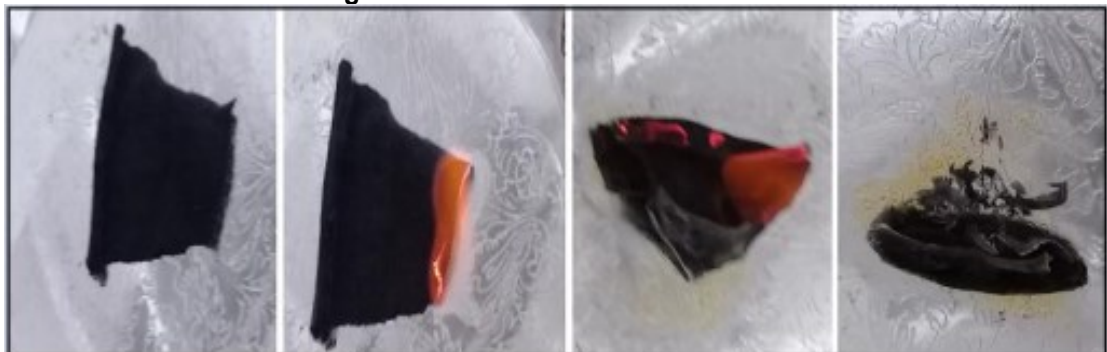
Figura 16 – Teste de combustão da malha
