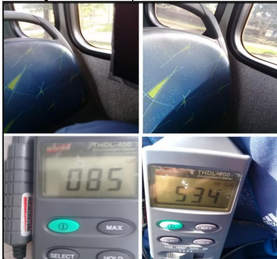
Figura 36 – Teste de bloqueio de luz dentro do ônibus
