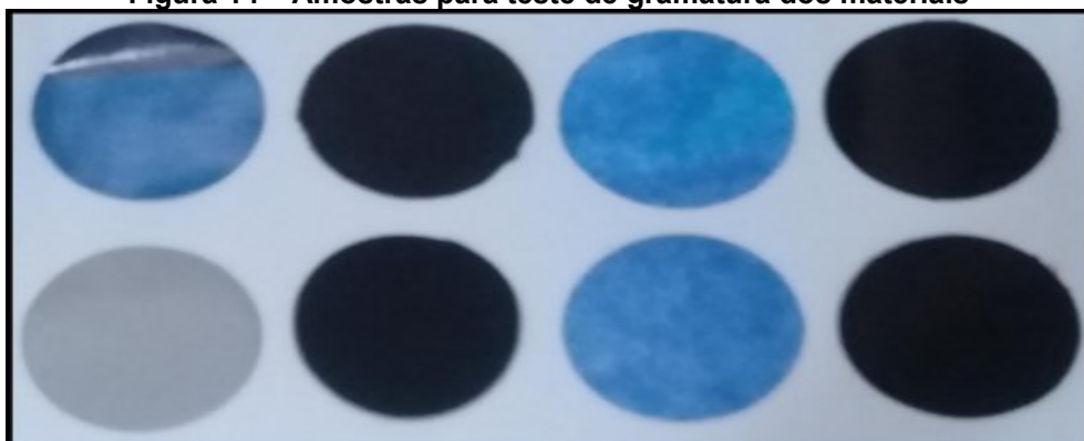
Figura 14 – Amostras para teste de gramatura dos materiais
