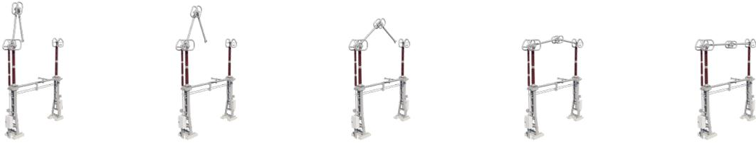
**Figura 24 – Animação do fechamento de uma chave seccionadora virtual, em vários estágios do movimento.**
