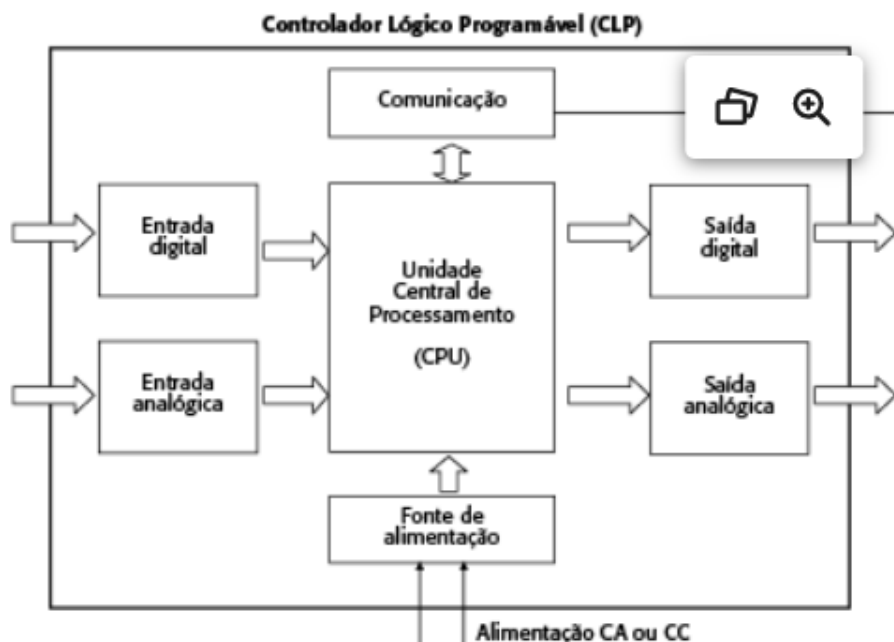
Figura 12 – Diagrama de blocos simplificado do CLP
