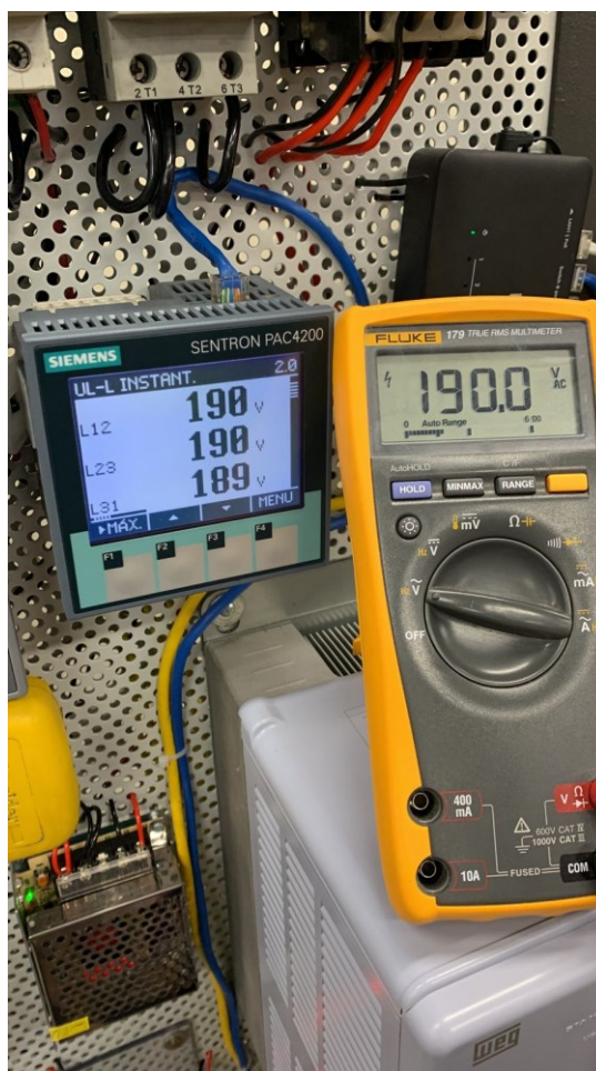
Figura 53 – Comparação da medida de tensão entre o PAC e um voltímetro
