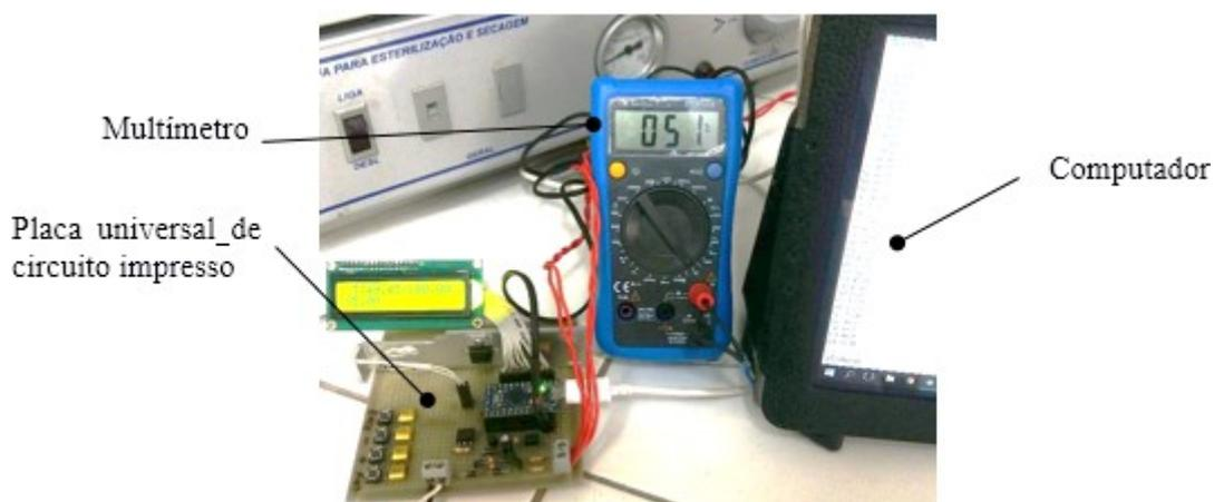
**Figura 3.2** - Sistema de controle de temperatura, multímetro e computador
