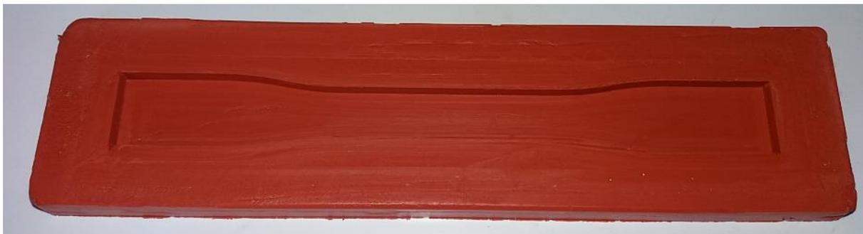
**Figura 3.8** - Molde de silicone do tipo II
