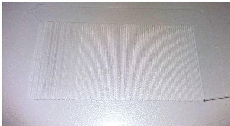
**Figura 4.26** - Imagem do CDP5 com GLAF, espessura de 0,3 mm a 115 °C
