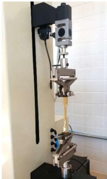
**Figura 3.10** - Equipamento utilizado para ensaio de tração
