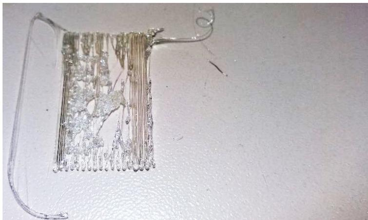
**Figura 4.24** - Imagem do CDP3 com GLAF, espessura de 0,4 mm a 120 °C
