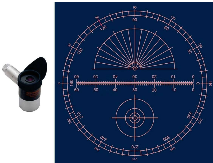
Figura 45 – O retículo da ocular Celestron Micro-Guide . A espessura das linhas e círculos inscritos é de 15\ \mu\text{m} .
