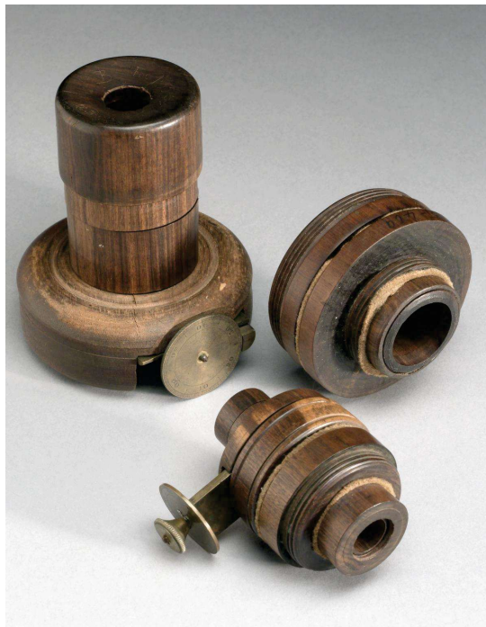
Figura 4 – Datado entre 1780 e 1800, este micrômetro de ocular filar foi fabricado pelo astrônomo William Herschel para os telescópios que ele utilizou.
