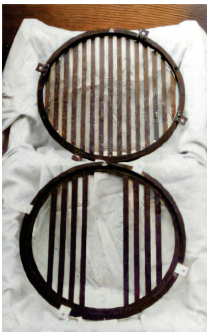
Figura 55 – Grade convencional e a grade interrompida para uso em duplas fracas.
