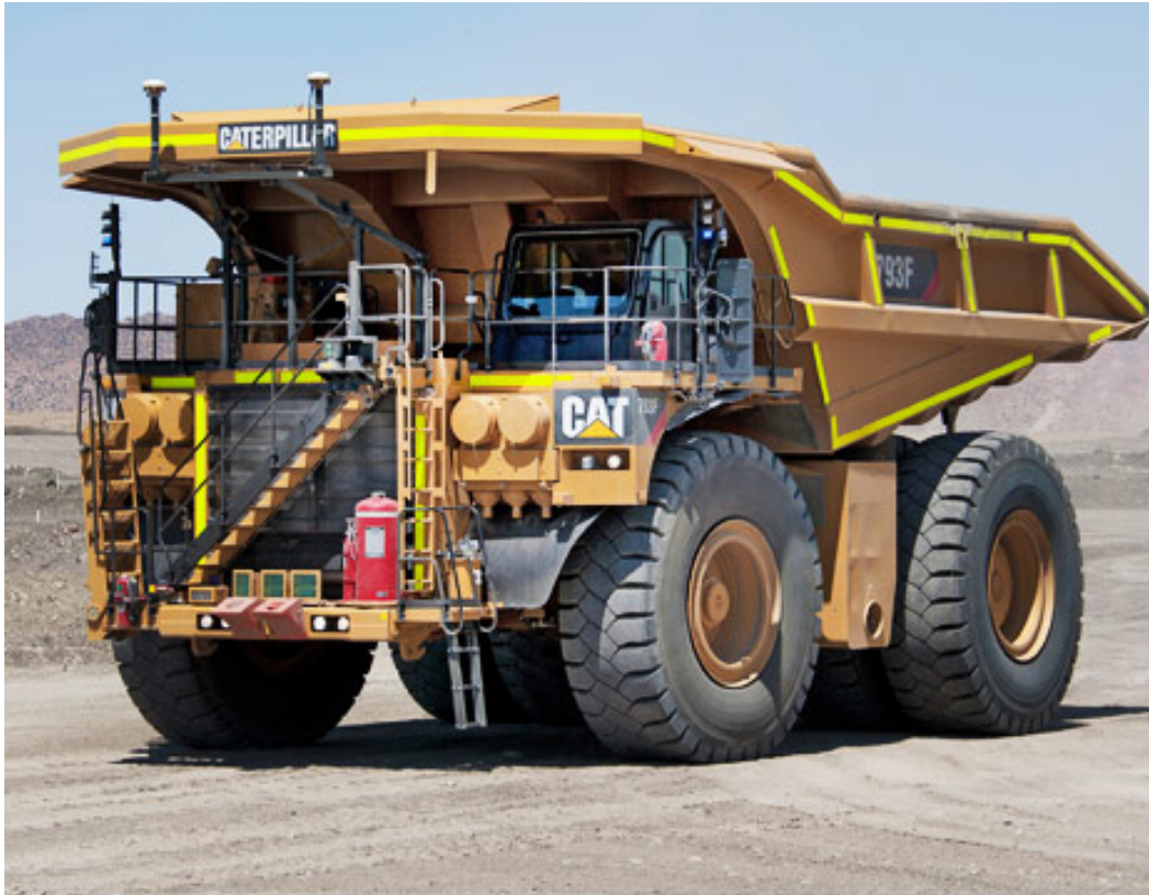
Figura 3 – Caminhão autônomo Cat 793F em teste na Mina Navajo.
