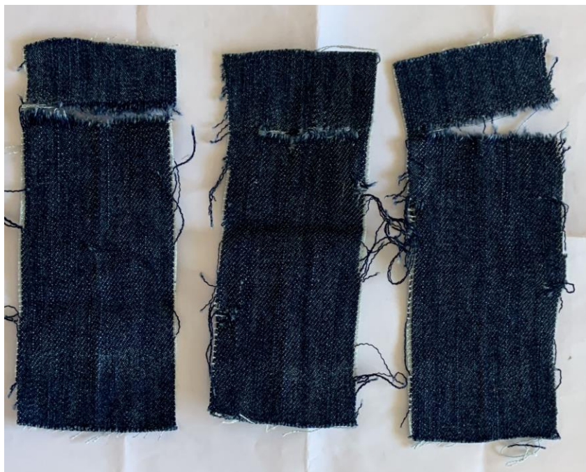
Figura 17 - Amostras rompidas após os ensaios de resistência a tração
