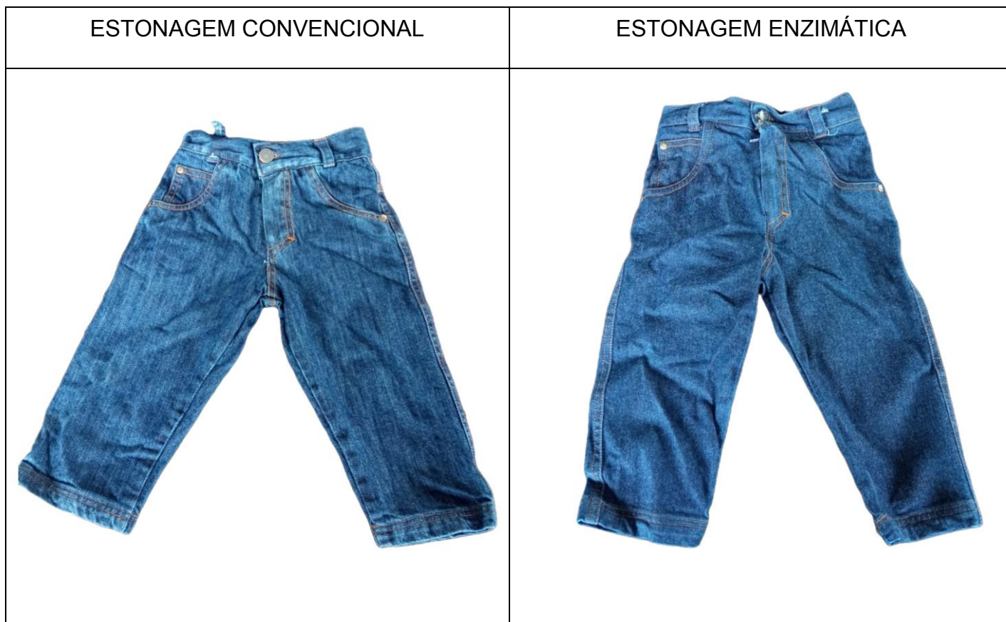
Figura 13 - Resultado das lavagens utilizando jeans 100% algodão (CO)
