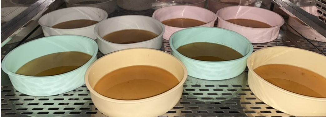
Figura 4 – Elaboração de filmes de amido contendo AgNPs.
