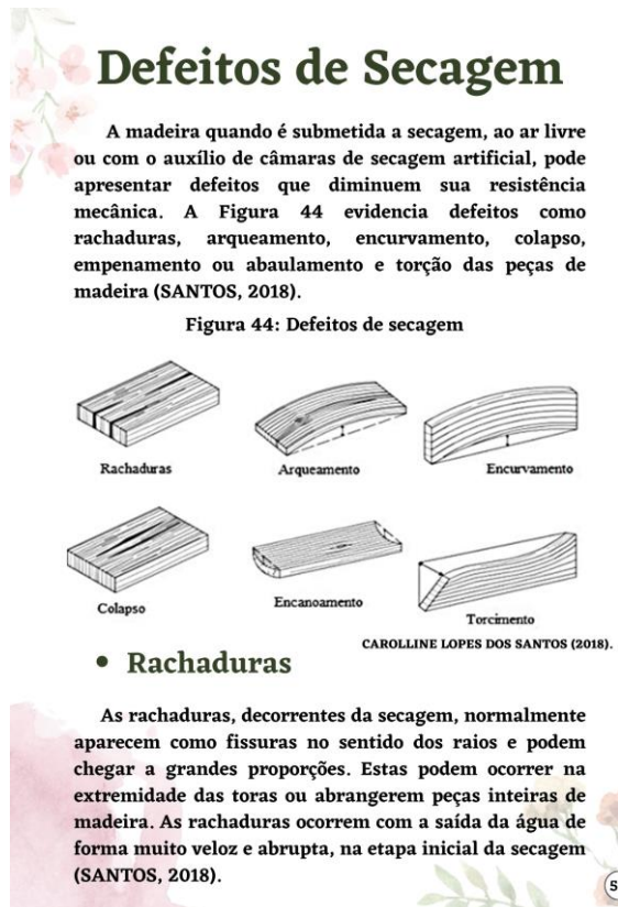
Figura 17: Defeitos de secagem
