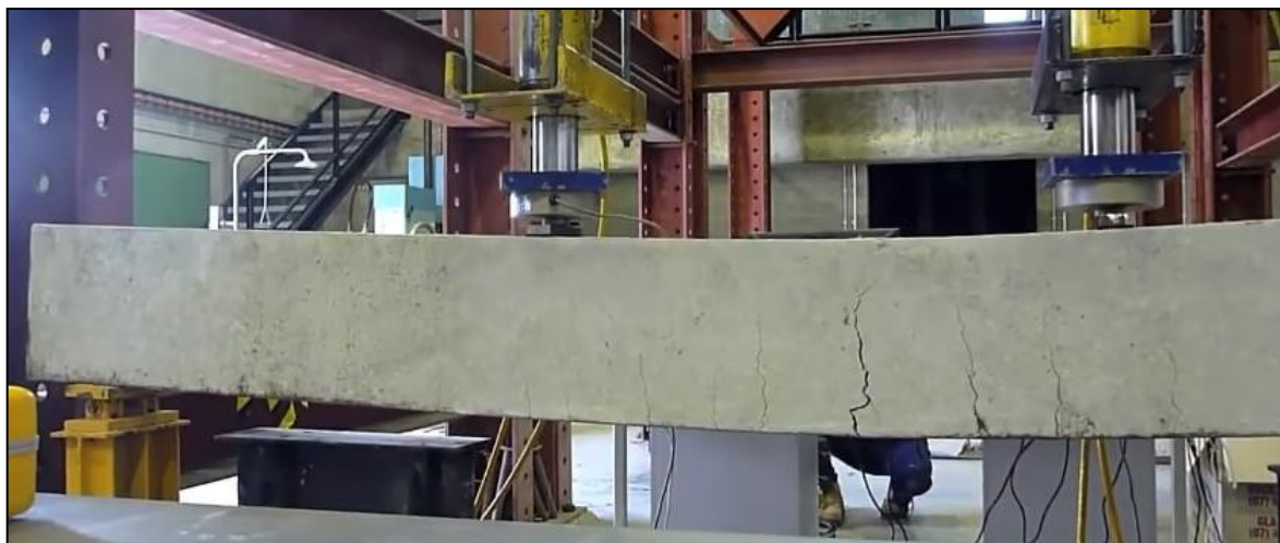
Figura 2 – Viga fissurada em ensaio à flexão
