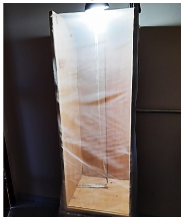
Figura 8: Torre de voo para operárias de Apis mellifera utilizada no bioensaio 3, com a fonte de luz.
