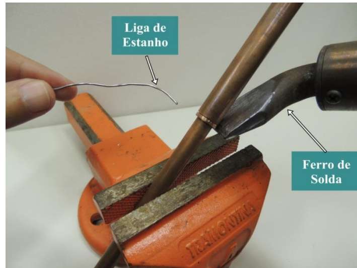
Fotografia 9 - Processo de soldagem de um Termossifão #3.
