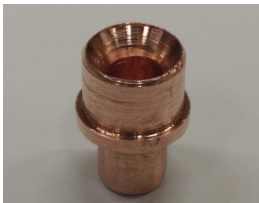
Fotografia 10 - Peça de cobre para junção de tubos com diâmetros diferentes no Termossifão #3.
