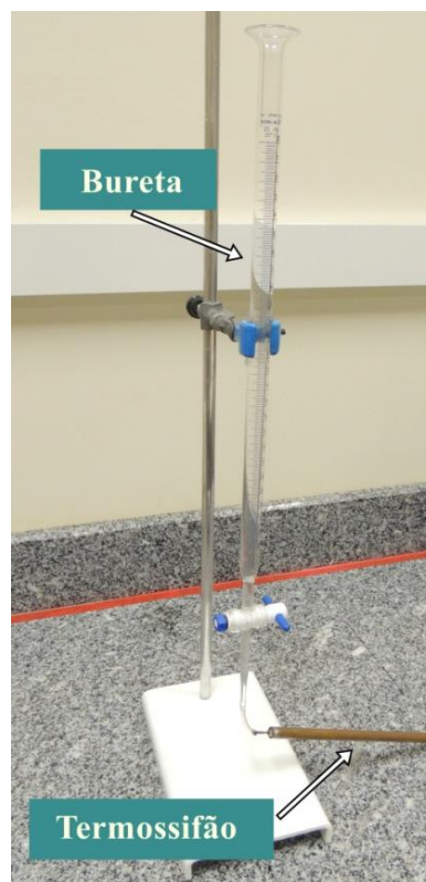
Fotografia 12 - Processo de preenchimento de um termossifão.
