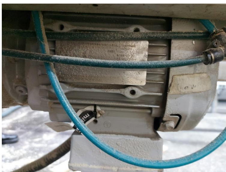
Figura 13 – Motorreductor da Esteira de Correntes Retas de Alimentação.
