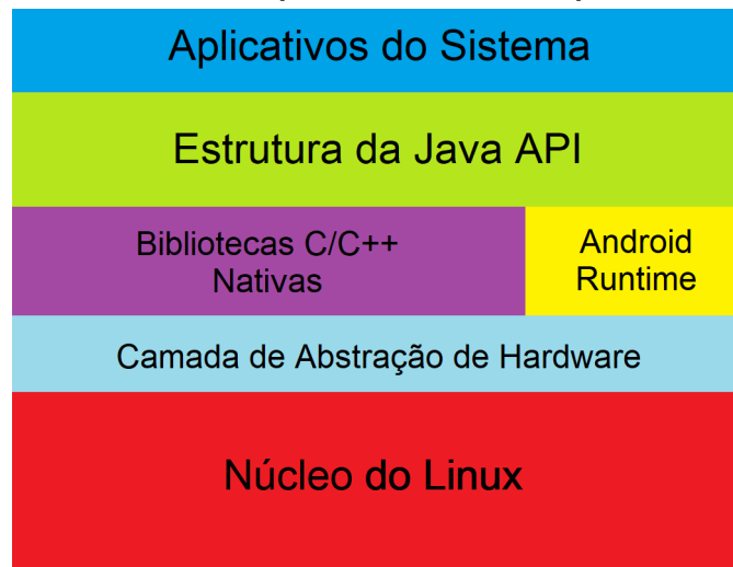
Figura 8 – Camadas da arquitetura do sistema operacional Android
