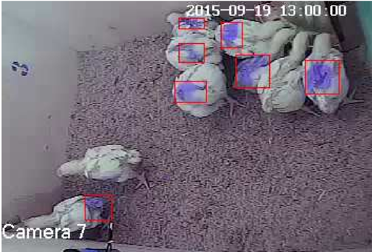
Figura 6 – Retângulos envolventes das regiões detectadas.
