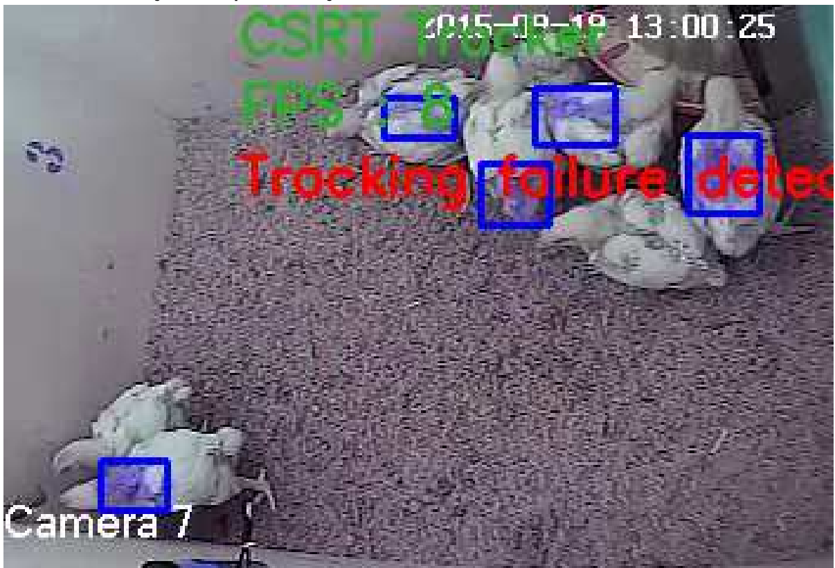
Figura 9 – Sistema retornando que houve erro no rastreamento dos frangos, o que será corrigido com uma re-execução da etapa de detecção.
