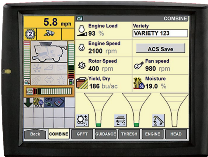
Figura 36 – Tela AFS Pro 700 na configuração de colheitadeira.
