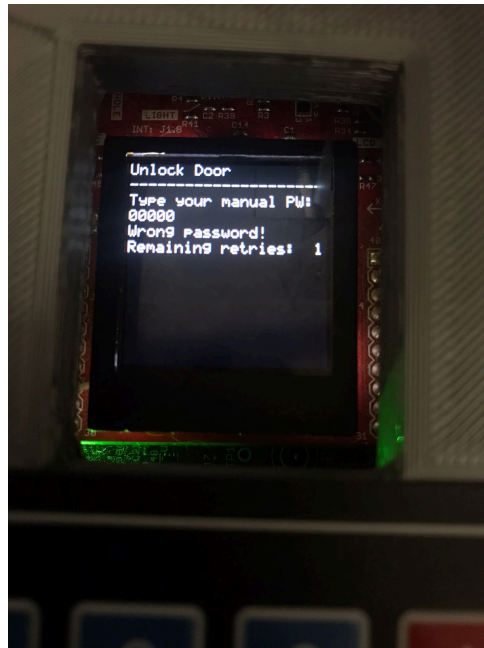
Figura 45 – Tela de entrada de senha do usuário com senha incorreta digitada antes da terceira tentativa
