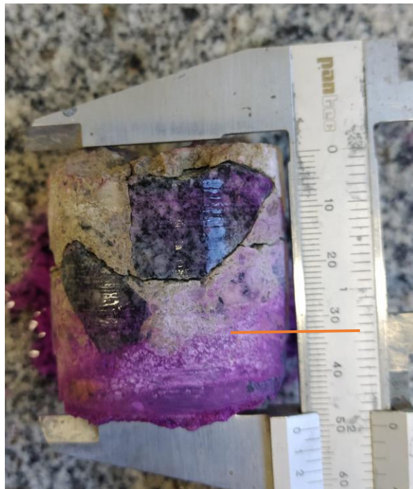
Figura 45 – Profundidade de carbonatação do corpo de prova 2.
