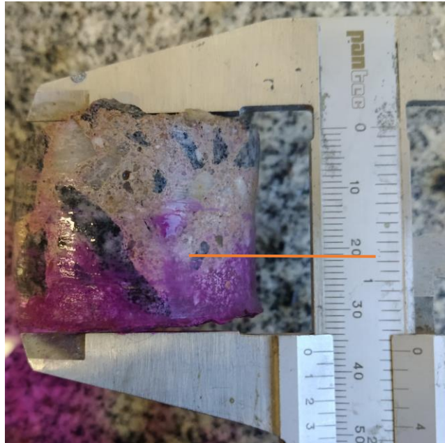
Figura 46 – Profundidade de carbonatação do corpo de prova 3.
