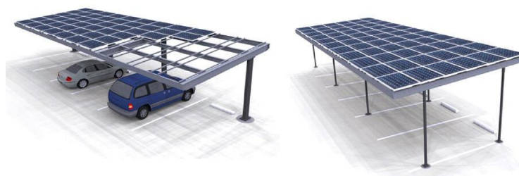
Figura 24 - Estrutura de fixação de módulos fotovoltaicos em solo com estrutura para estacionamento de veículos.
