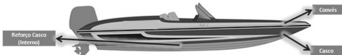
Partes Principais - Utilizam Laminação Spray Up (Posto de Trabalho Gargalo - J4)
