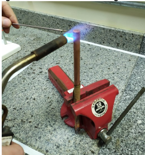
Fotografia 10 – Processo de brasagem do tubo
