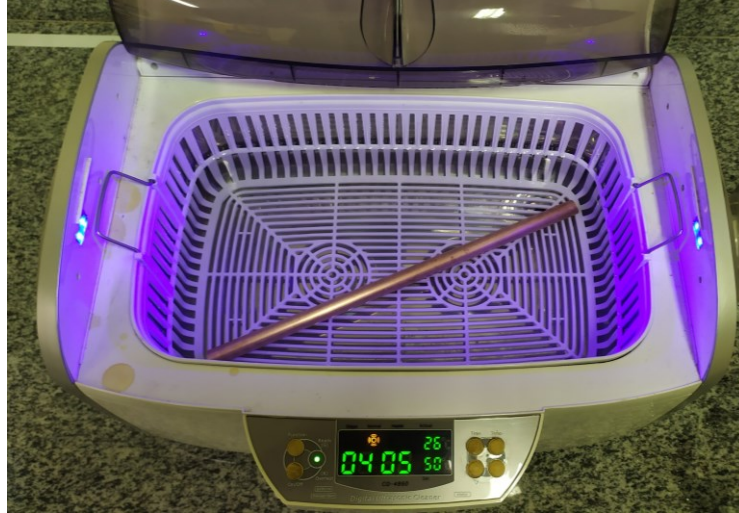
Fotografia 9 – Banho ultrassônico contendo os componentes imersos
