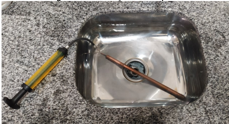
Fotografia 12 – Verificação da estanqueidade
