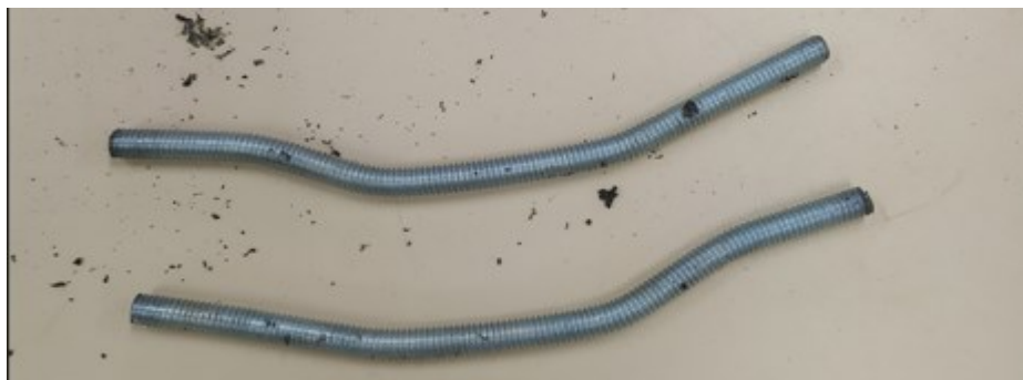
Figura 31: Barra roscada CP2 após ensaio.
