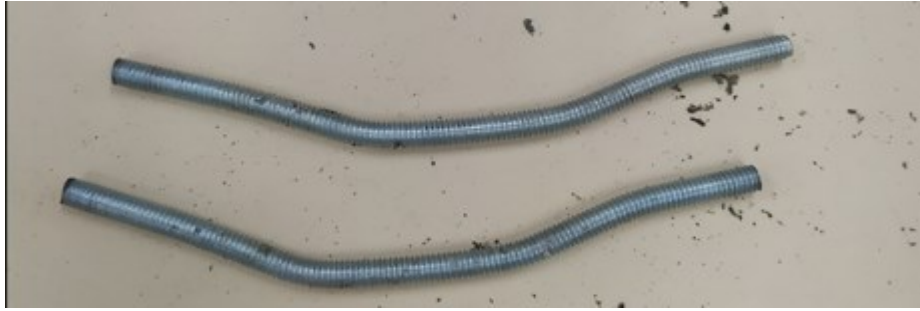
Figura 32: Barra roscada CP3 após ensaio
