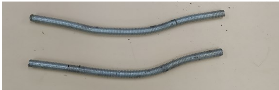
Figura 30: Barra roscada CP1 após ensaio.
