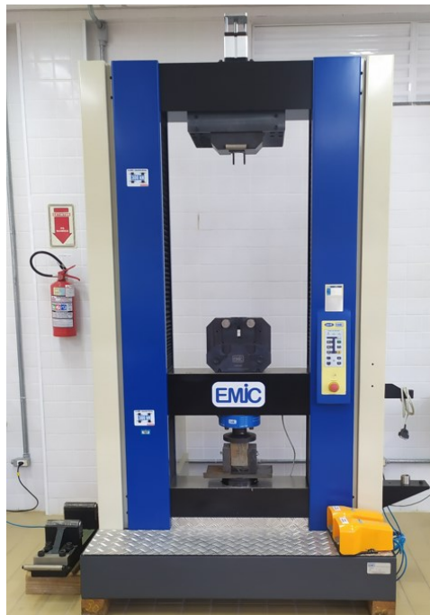
Figura 19: Modelo da máquina universal de ensaios (EMIC DL30000)
