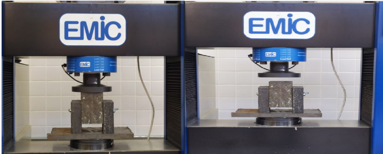
Figura 28: Corpo de prova 5 antes e depois do ensaio
