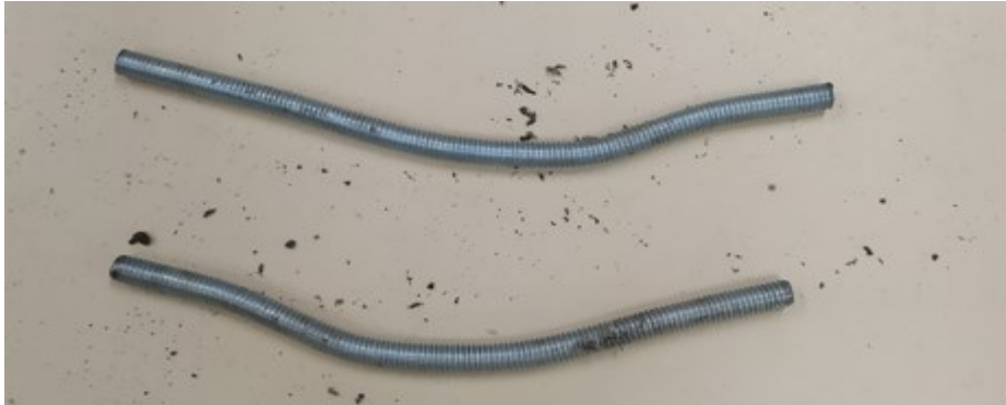
Figura 33: Barra roscada CP4 após ensaio.
