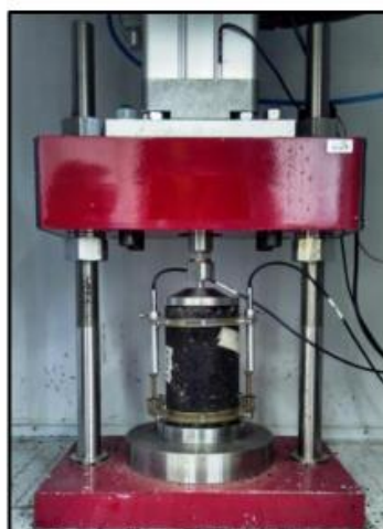
Figura 11 - Ensaio de Flow Number
