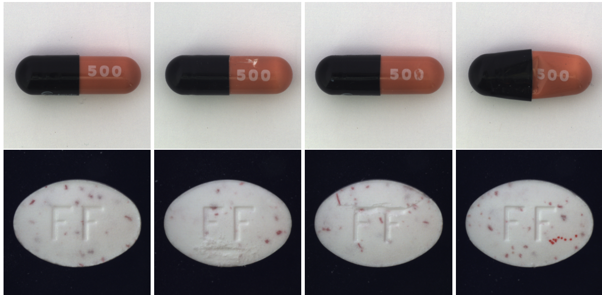
Figura 22 – Exemplos dos objetos Cápsula e Pílula da base MVTec-AD, onde o objeto da primeira imagem é livre de anomalia, e os outros são exemplos de anomalias variadas contidas na base de imagens.
