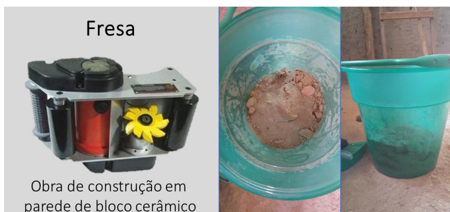
Figura 29 – Resíduo de parede de bloco cerâmico utilizando a fresa para corte
