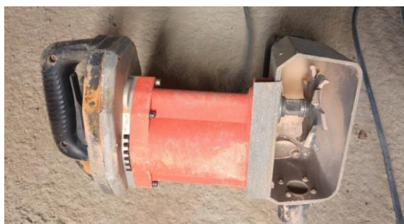
Figura 7 – Cortadora de parede com fresa de 32mm
