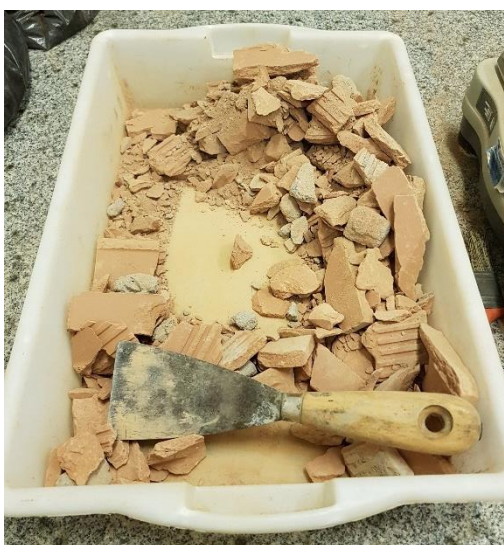
Figura 27 – Resíduo de talhadeira sendo misturado para ensaio de massa unitária
