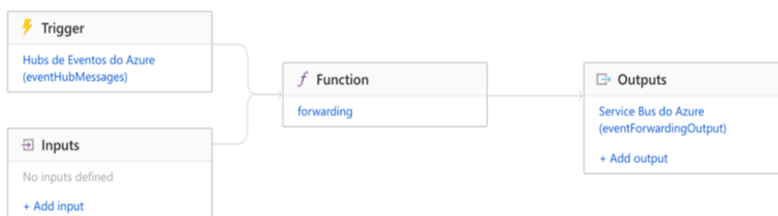
Figura 3 - Arquitetura de Função do Azure Function
