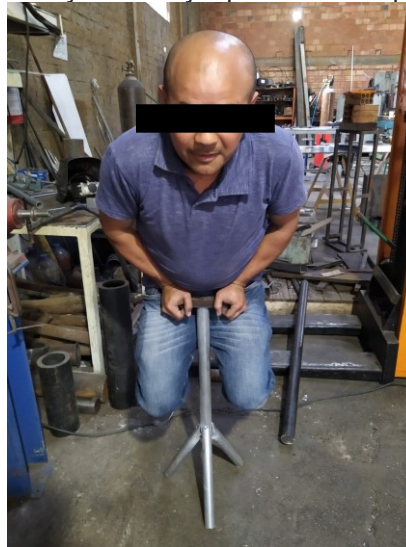
Figura 21: Demonstração da força que a haste suporta (peso: 80kg)
