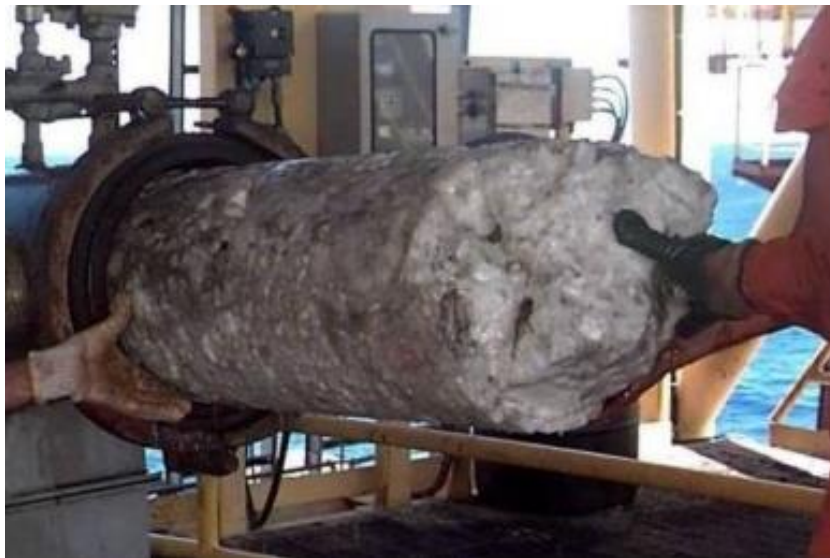
Figura 1.2 – Plugue de hidrato formado em uma linha submersa
