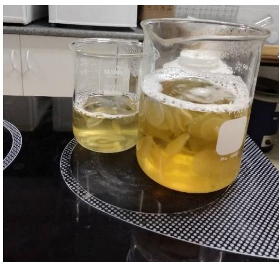
Figura 27. Processo de purificação de membranas em chapa de aquecimento.
