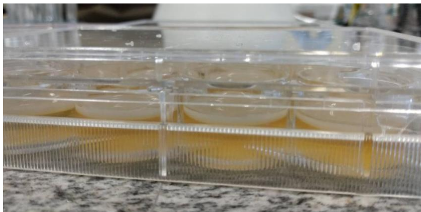
Figura 24. Cultivo de nanocelulose em placas multipoços de 12 poços pós incubação de 07 dias a 28°C em meio HS modificado.
