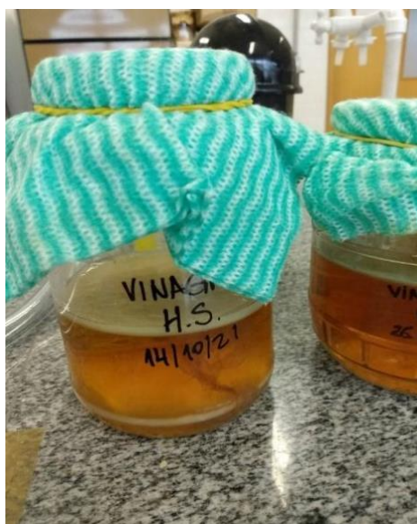
Figura 12. Frasco com formação de NCB em meio HS após 7 dias a 28°C sob cultivo estático a partir de inóculo com vinagre de maçã.
