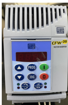
Figura 8 – Inversor de frequência instalado no tribômetro
