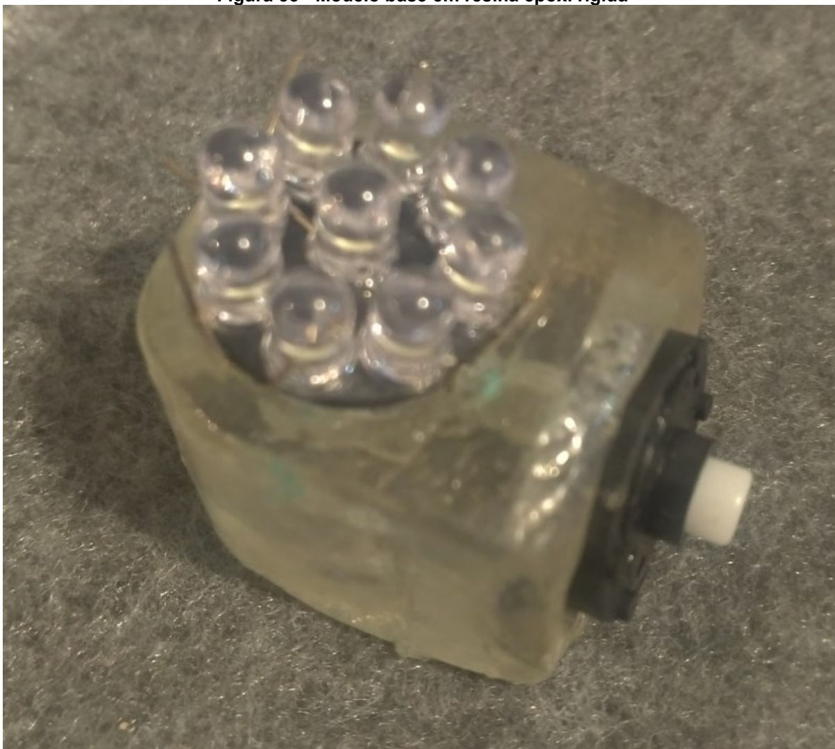
Figura 55 - Modelo base em resina epóxi rígida
