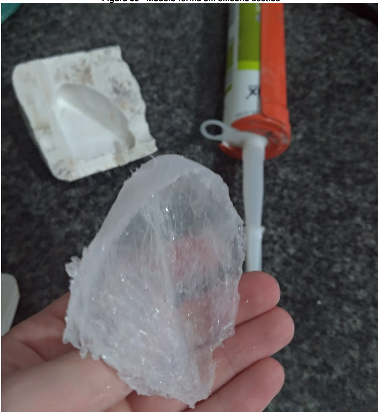
Figura 56 - Modelo forma em silicone acético
