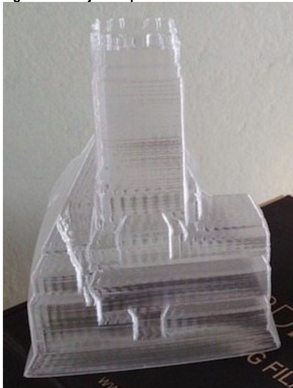
Figura 53 - Objeto impresso em ABS translúcido
