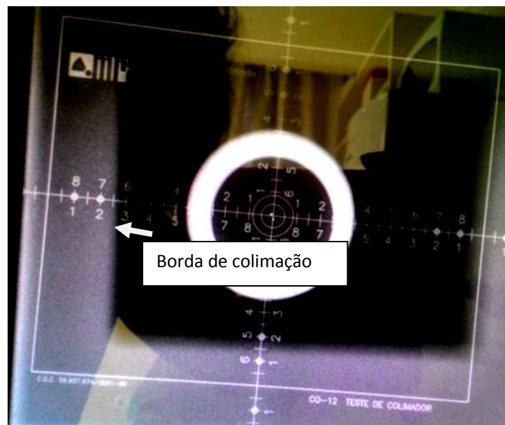
Figura 30 - Borda de colimação com desvio maior que 2 cm à esquerda.
