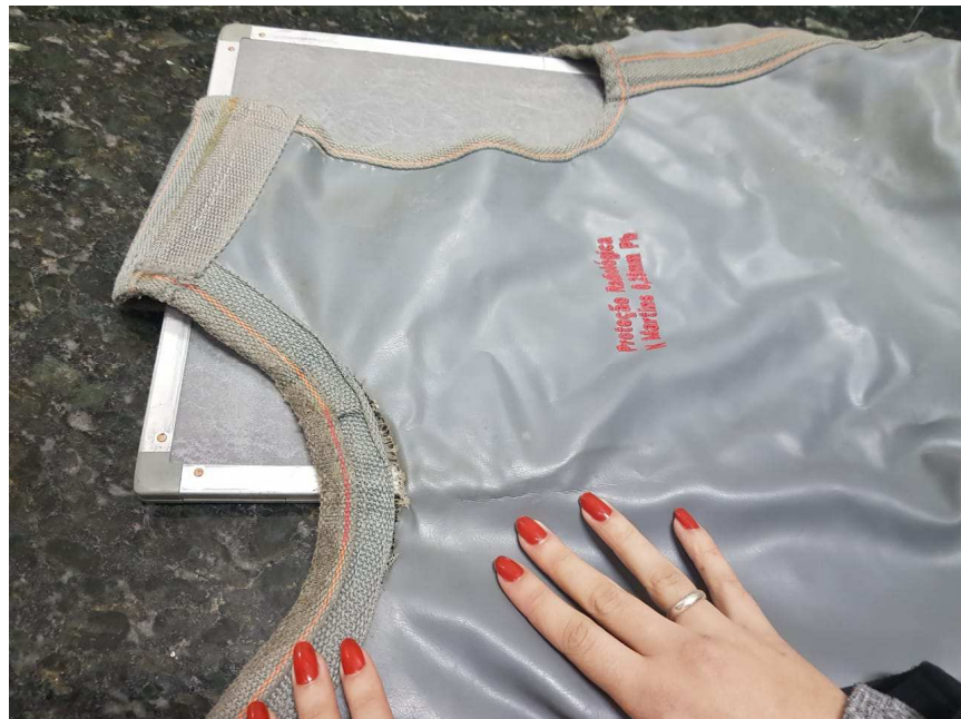
Figura 17 – Integridade das vestimentas pumbíferas. Teste de palpação e teste de imagem Fonte: Autoria própria.
