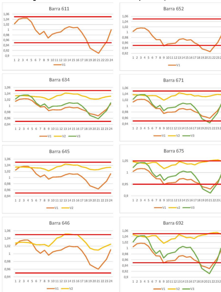
Figura 36 - Tensão nas barras com penetração de 50%
