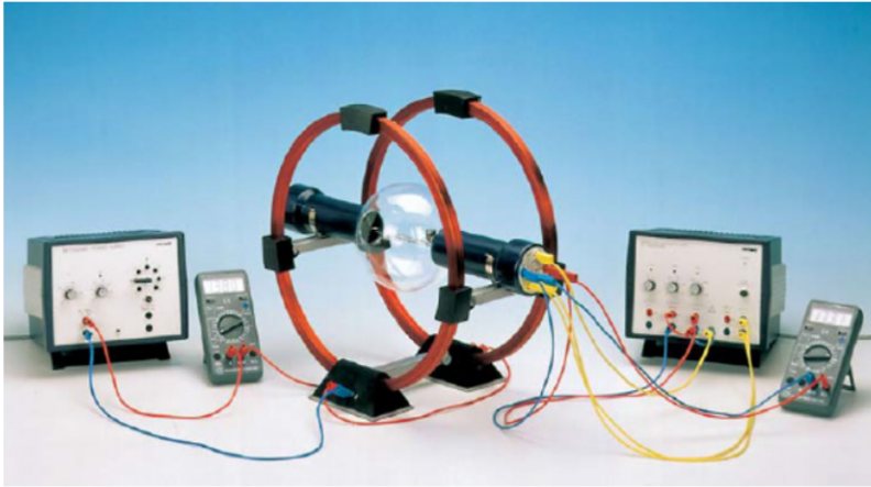
Figura 114 - Experimento didático da carga/massa Fonte - PHYWE (2015)
