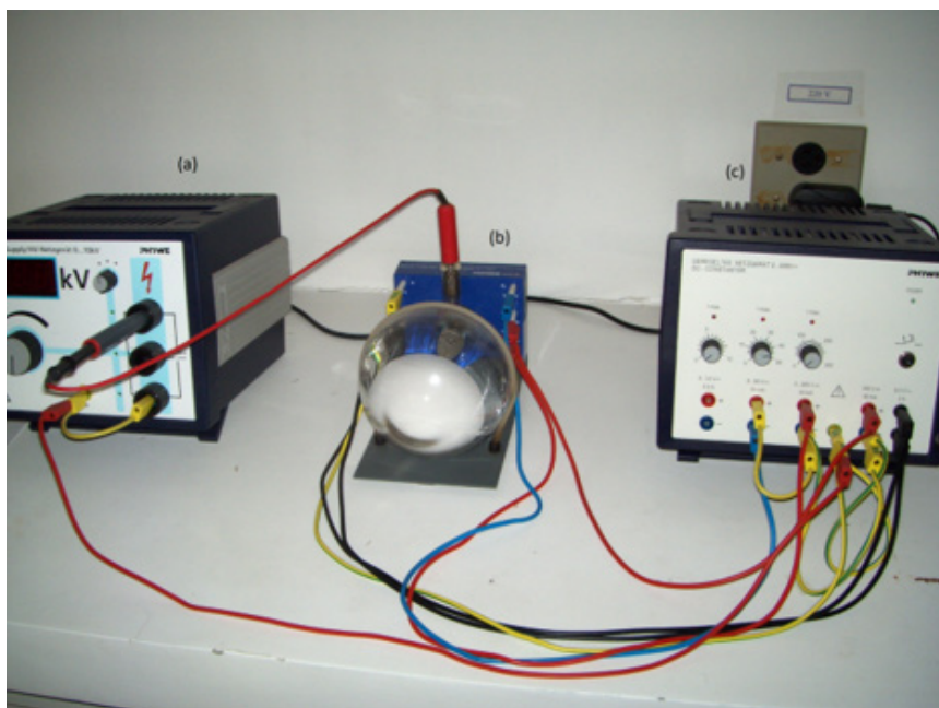
Figura 120 – Detalhe do experimento didático de difração de elétrons: (a) fonte de tensão; (b) tubo de difração de elétrons com suporte; (c) alimentação regulável de energia para o feixe de elétrons.
