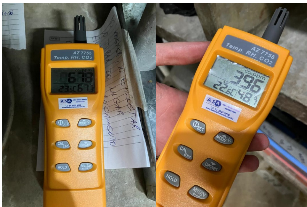
Figura 23 – Medidor de CO 2 (AUTOR, 2023)
