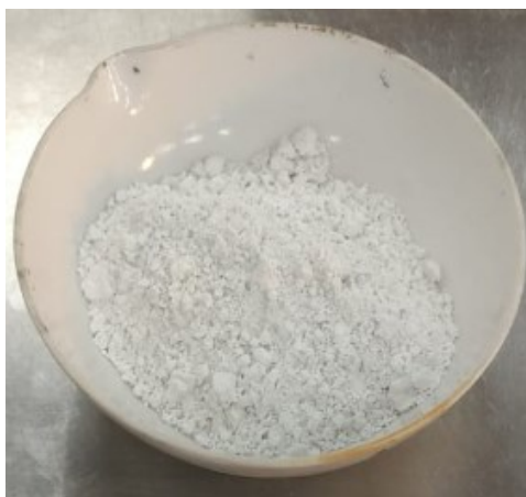
Figura 14 - Escória de alto forno após moagem (AUTOR, 2023)
