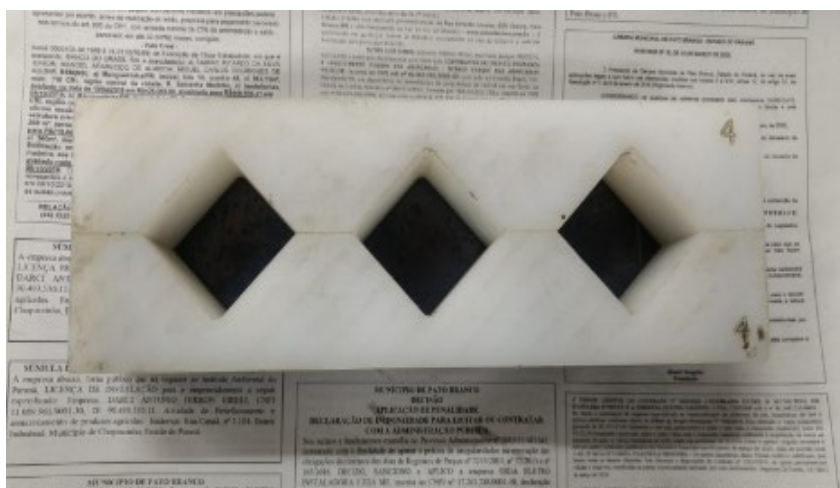
Figura 20 - Moldes cúbicos 3cm (AUTOR, 2023)
