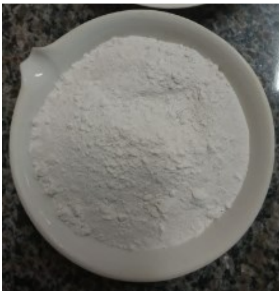
Figura 17 - Gipsita em sua forma anidra (Anidrita) depois do processo de calcinação (AUTOR, 2023)
