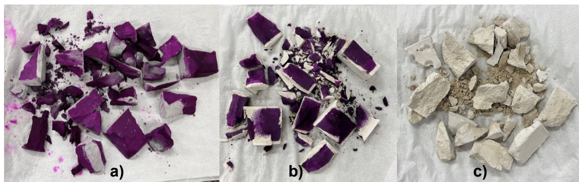
Figura 38 - Amostras de pasta com aplicação de fenolftaleína após 28 semanas de exposição à carbonatação natural (a) CP IV; b) CSS 85:10; c) CSS 75:20 (AUTOR, 2023)
