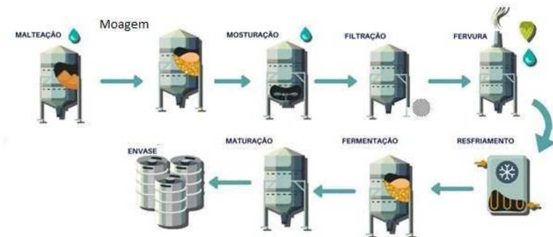
Figura 7: Processo de produção de cervejas
