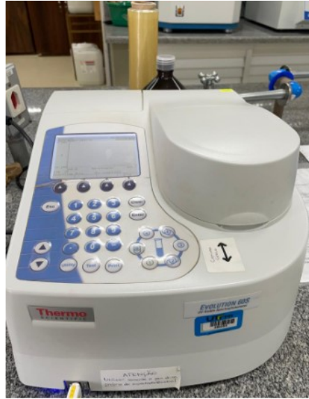
Figura 6 - Espectrofotômetro utilizado para análises de UV-Vis.
