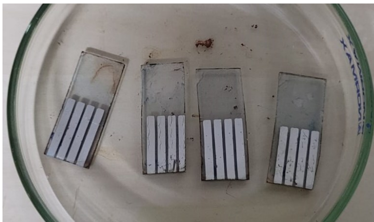
Figura 25 – Dispositivos optoeletrônicos construídos.
