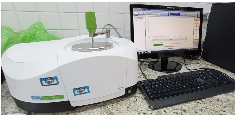
Figura 14 - Equipamento utilizado para realizar a espectroscopia de infravermelho com transformada de Fourier (FTIR). Aparelho da UTFPR, campus Londrina.
