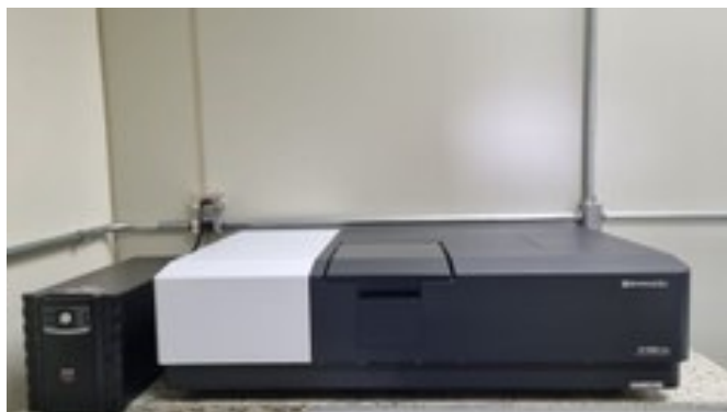
Figura 15 - Espectrofotômetro utilizado nas medidas de absorção, modelo UV-VIS-NIR UV 3600 Plus, da marca Shimadzu, do laboratório da UTFPR campus Londrina.
