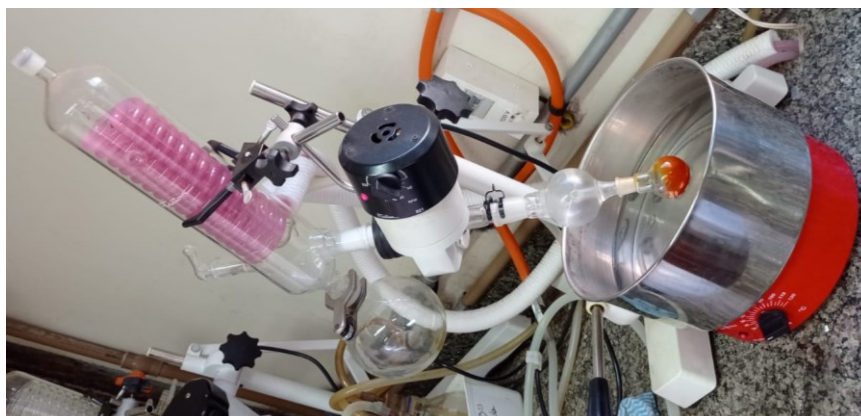
Figura 21 - Processo de evaporação do THF.
